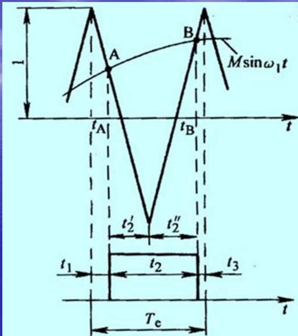
在图中截取了任意一段正弦调制波与三角载波的相交情况。交点A是发出脉冲的时刻 $t_A$ ，B点是结束脉冲的时刻 $t_B$ 。 $t_c$ 为三角载波的周期； $t_1$ 为在 $t_c$ 时间段内脉冲发生以前(即A点以前)的间歇时间； $t_2$ 为A,B之间的脉宽时间； $t_3$ 为在 $t_c$ 时间段以内B点以后的间歇时间。显然， $t_c = t_1 + t_2 + t_3$ 。
