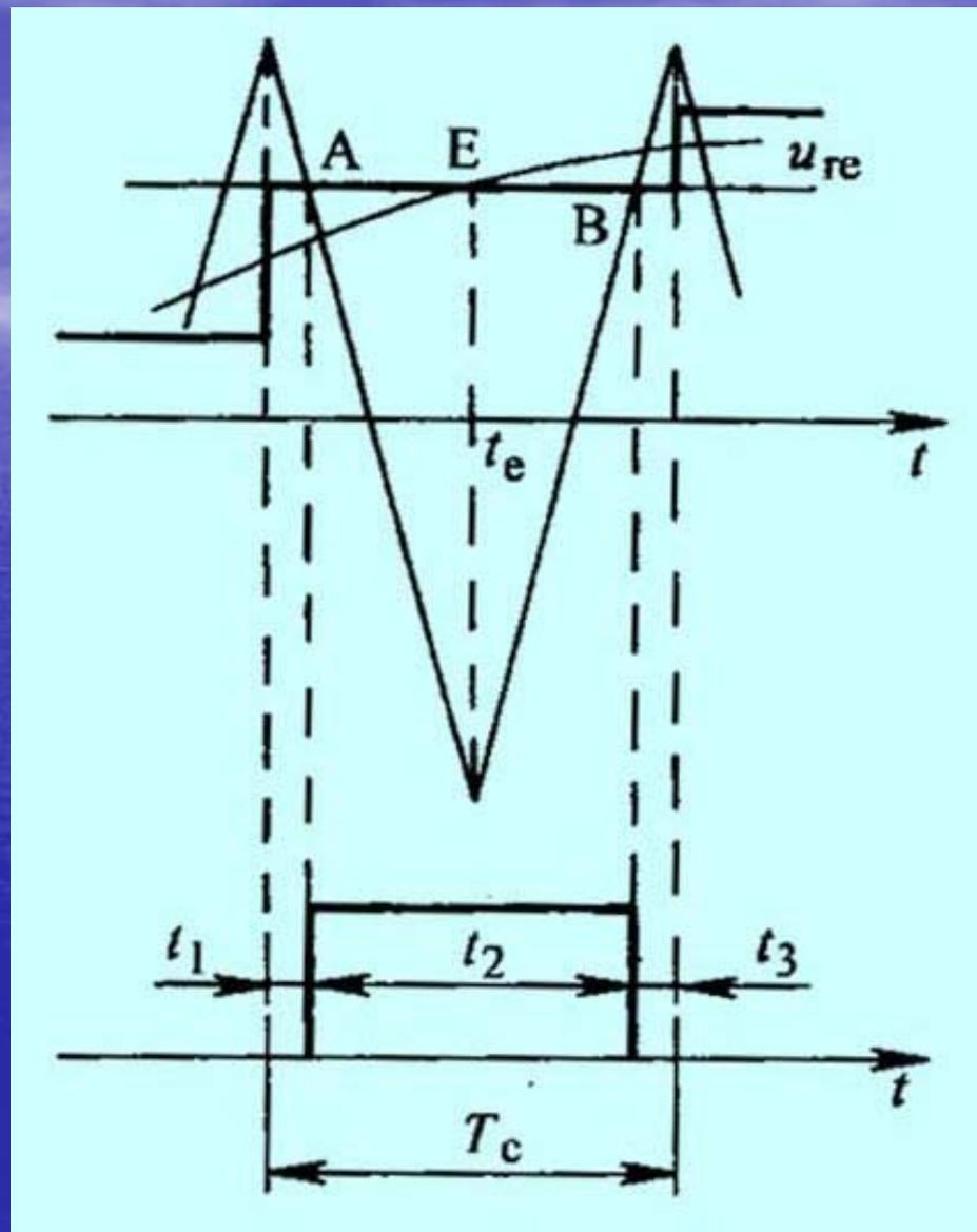
在规则采样法中，三角载波每个周期的采样时刻都是确定的，都在负峰值处，不必作图就可计算出相应时刻的正弦波值。例如采样值应依次为  $m\sin \omega_1 t_e$ ， $m\sin(\omega_1 t_e + t_c)$ ， $m\sin(\omega_1 t_e + 2t_c)$ ，.....，因而脉宽时间和间歇时间都可以很容易计算出来。由上页图可得规则采样法的计算公式：
