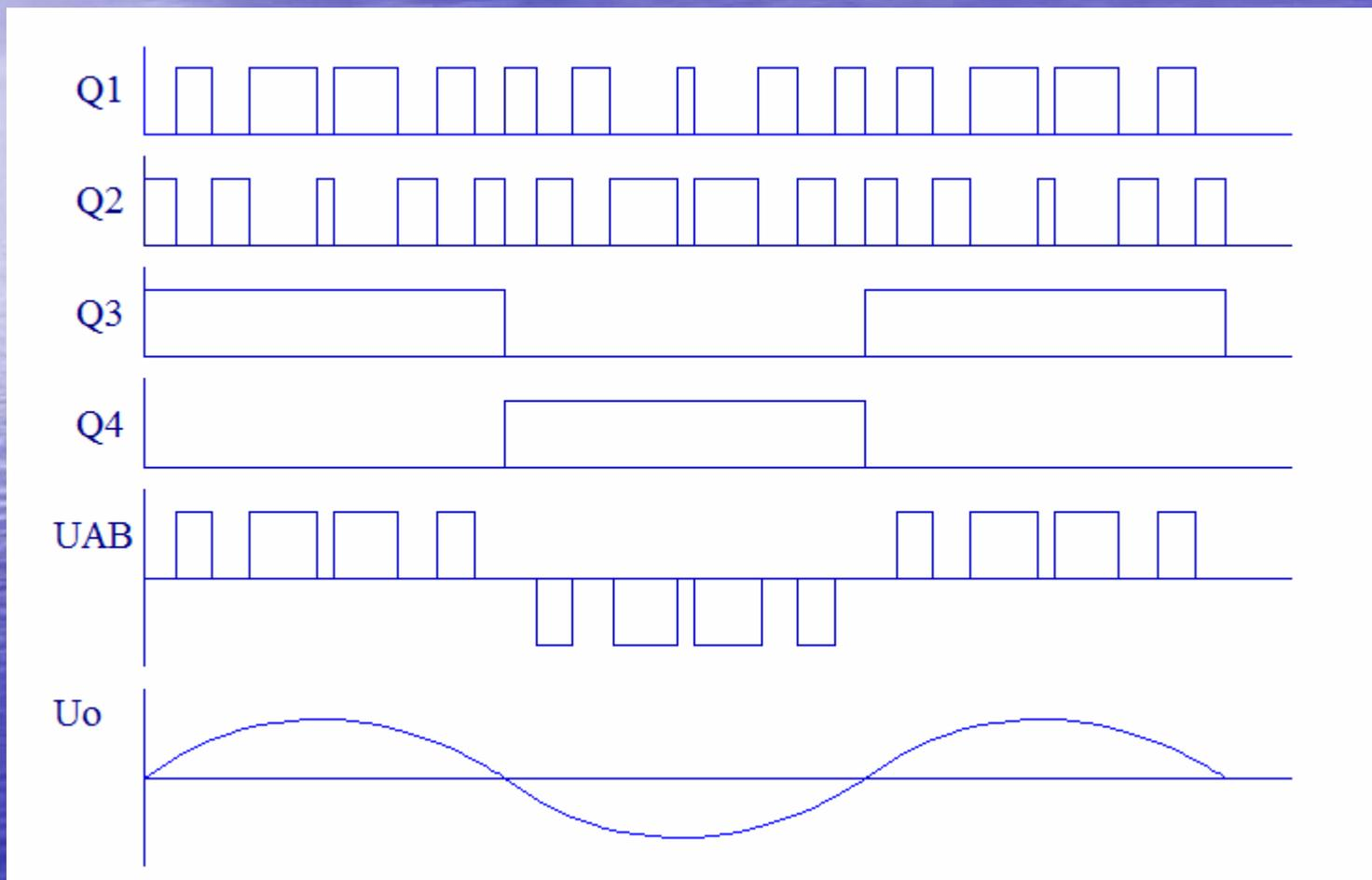
从上面的驱动时序可以看出典型的单极性调制有如下特点：高频臂Q1,Q2两个功率管工作在高频状态，低频臂Q3,Q4两个功率管工作在低频状态，只有一半的功率管有开关损耗，和其他4个功率管都工作在高频状态的调制方式相比，总的开关损耗只有一半。由此可以知道，高频臂Q1,Q2两个功率管工作在高频状态，损耗比低频臂Q3,Q4两个功率管工作在低频状态要高，因而发热比较大，寿命要短。于是人们提出了一种改进型的单极性调制，其原理是让每个功率管都轮流半个基波周期工作在高频状态，半个周期工作在低频状态，其时序如下图：
