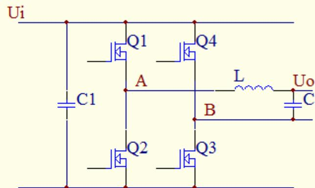
从UAB的波形可以看出，两路双极性调制经过全桥功率管的叠加之后最终的UAB波形变成了单极性，而且频率加倍，这就是这种调制方式称为单极性倍频调制的原因。这种调制方式波形完美，对各种负载的适应性好，因为倍频输出，LC的体积和成本可以比较小，缺点是4个功率管都工作在高频状态，因而开关损耗比较大。这种调制方式用模拟电路实现起来比较方便，所以也是D类功放的首选电路。用模拟电路实现的方法很多，其中一种方法是先用2个比较器，正弦波基波信号分别输入到2个比较器的正端，两路互为反相的三角波载波分别输入到2个比较器的负端。比较器输出的两路信号分别用非门反相得到2路反相信号，再加上原来的比较器输出的两路信号一共4路信号分别驱动全桥电路的4个功率管就可以了。具体原理图如下：
