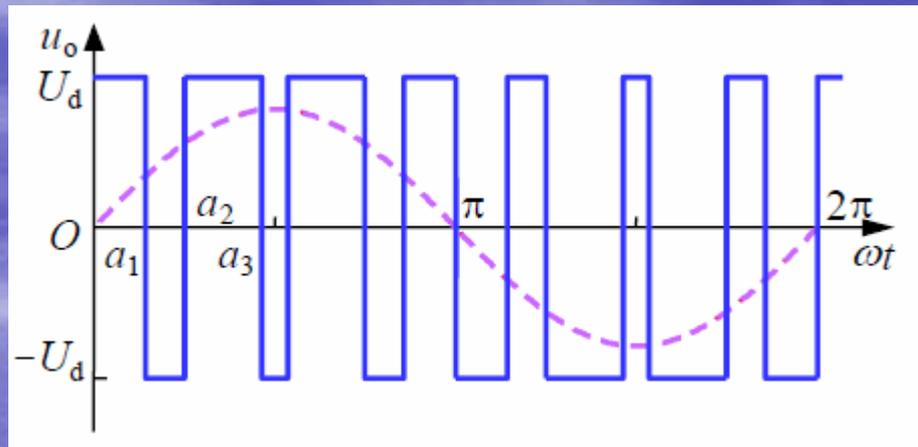
输出电压半周期内，器件通、断各3次（不包括0和 $\pi$ ），共6个开关时刻可控。为减少谐波并简化控制，要尽量使波形对称；
