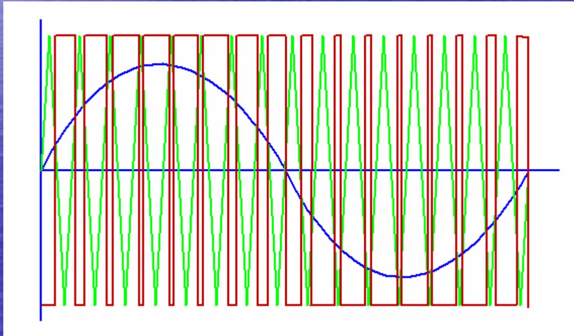
下面是全桥变换器中双极性SPWM调制的驱动波形：
