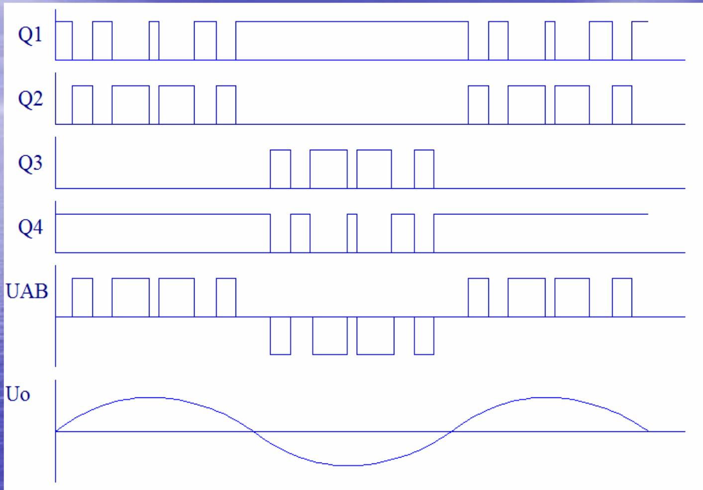
从上面得时序图可以看出，上面的4个功率管都是半个基波周期工作在高频状态，半个基波周期工作在低频状态，一直轮流工作了，这样4个功率管基本上做到了损耗均等，寿命均等。
