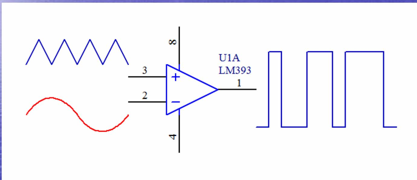
单极性SPWM在全桥电路中的驱动时序：
