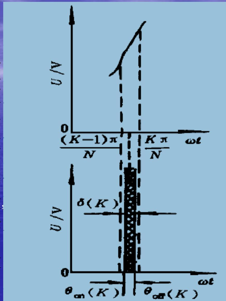
将正弦信号的正半周分为  $N$  等份, 则每份为  $\pi/N$  弧度, 脉冲高度为  $U_s/2$ ,  $U_s$  为直流母线电压, 设第  $K$  个脉冲宽度为  $\delta(K)$ , 则第  $K$  份正弦波面积与对应的第  $K$  个 SPWM 脉冲面积相等, 得
