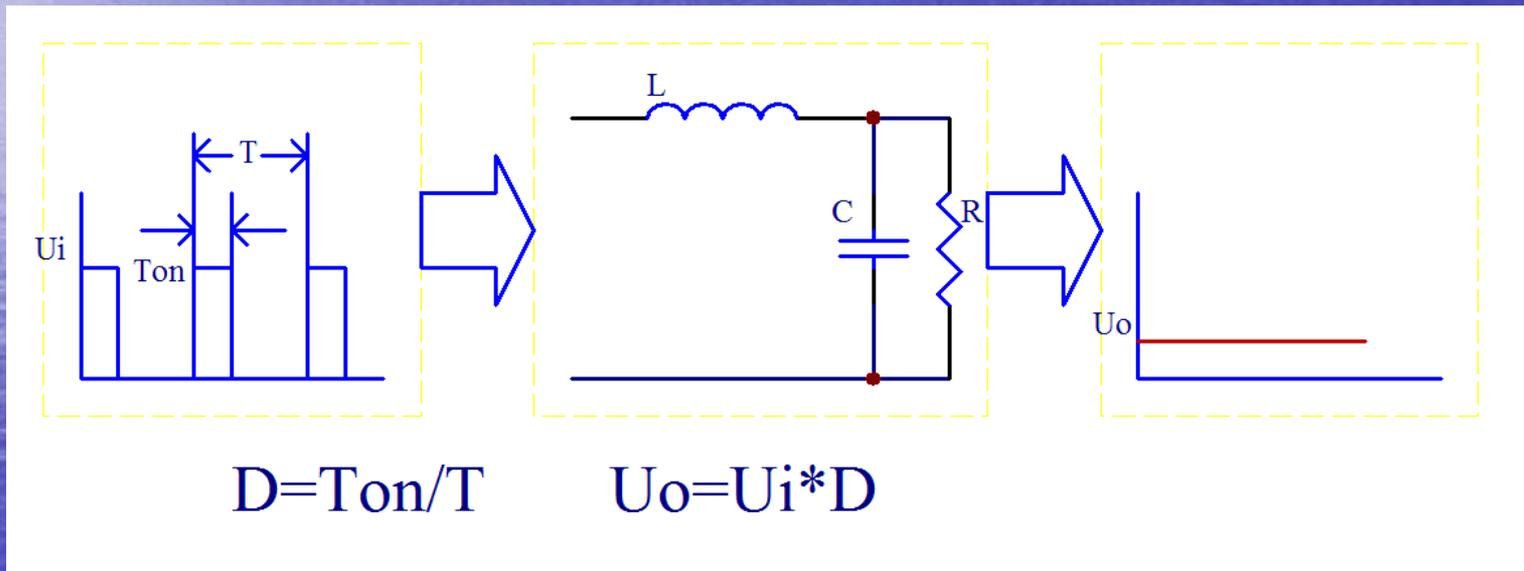
这就是在开关电源中我们常用的DC-DC变换的基本原理，在这个变换过程中实现了功率开关管工作在开关状态，理论效率为1.按照这个思路，如果对于交流电，如50HZ的正弦波，我们把它看成是有许许多多的呈阶梯状的直流信号组成的，这样我们就可以用许许多多的宽窄不等的脉冲来等效这个正弦波了，从而实现了功率管工作在开关状态。如果在一个正弦波周期内的脉冲个数比较多，就能精度比较高地通过LC滤波还原成正弦波，这就是SPWM调制的基本原理。
